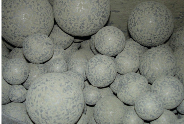
Şekil 9. Öğütme kolaylaştırıcı katkı kullanılmadığında bilyelerin çimento ile kaplanması [21]
