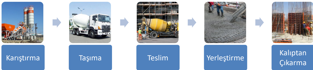
Şekil 11. Hazır betonun üretim ve kullanım süreci
