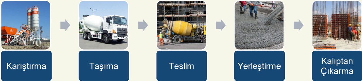
Şekil 1. Hazır betonun üretim ve kullanım süreci
