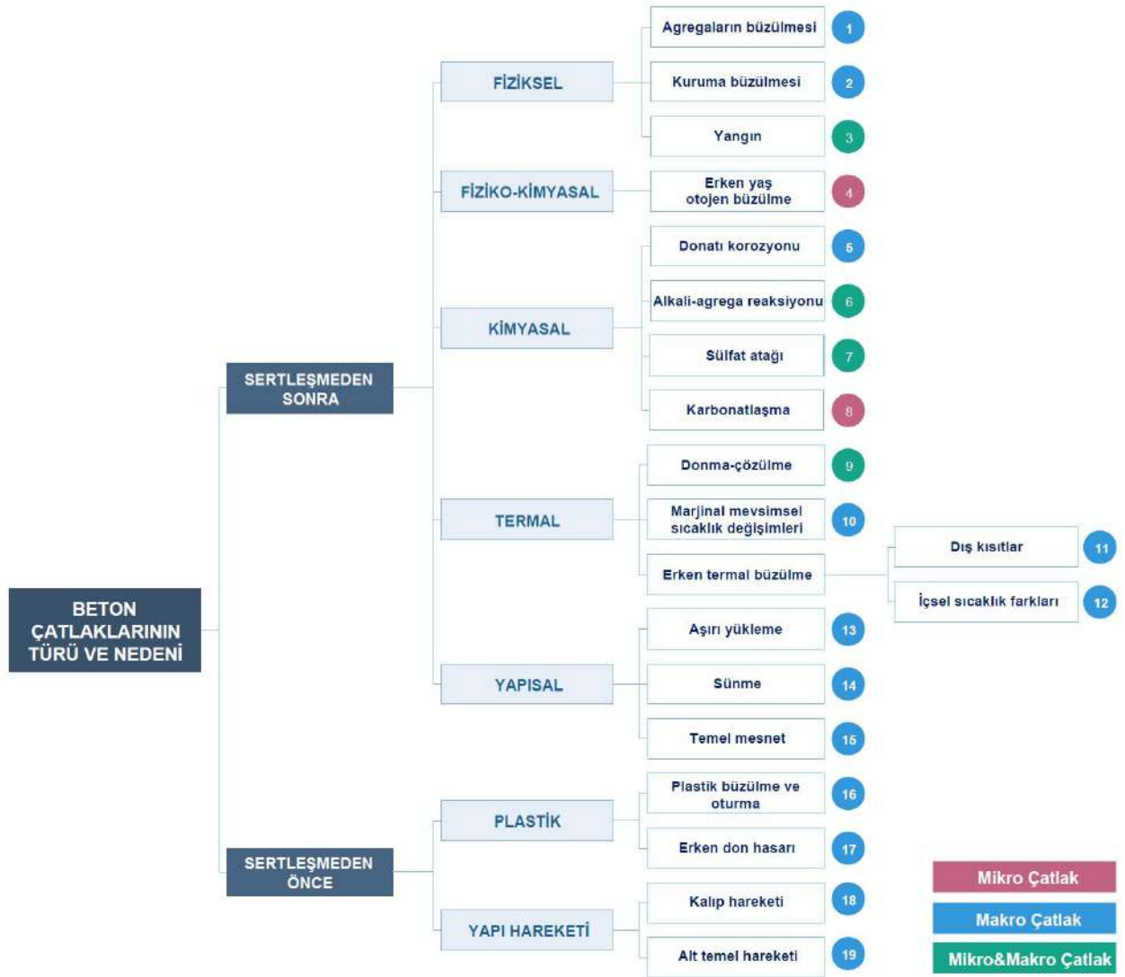
Şekil 7. Beton çatlaklarının türü ve nedenleri
