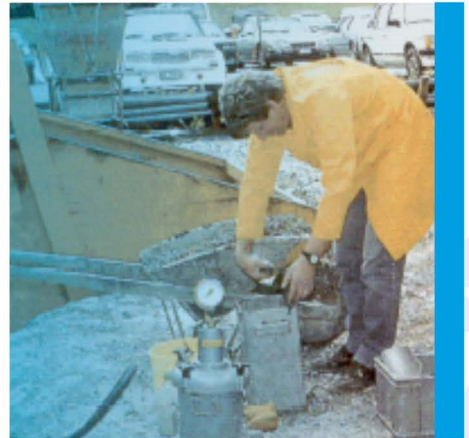
Taze betonda hava ölçümü
