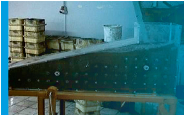
Şekil 5: Doldurma Kutusu Testi Deney Düzeneği [13]
